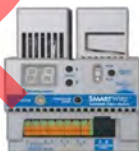
Conversor para sistema por descodificadores: Até 48 descodificadores, 3 linhas, 1.8Km por linha ou 3km em anel fechado. Compatível com todas as eletroválvulas 24V.
