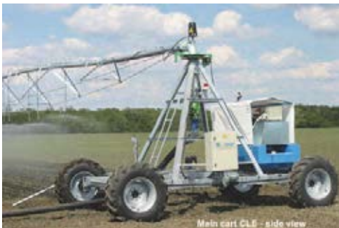
CENTERLINER - centro móvel, desloca-se de forma linear e circular.
