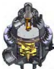
Filtro MSP 3" automático Limpeza automática por diferencial de pressão, regulável. Ciclo de limpeza dura 10 segundos.
