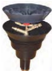
Aspersor CPR Com copo p/ relva natural. 26mts aos 6bar e com 15m³/h Rosca de 1 1/2"
