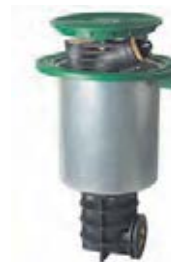
Aspersor Perrot VPM-2 43mts aos 7bar e com 50m³/h Rosca de 2 1/2"
