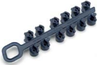
Árvore de bicos para os asp. 5000 Inclui oito de ângulo padrão (ângulo de trajetória de 25°) e quatro de ângulo baixo (ângulo de trajetória de 10°)
