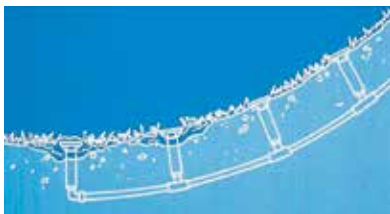
Sem válvula anti-drenagem
