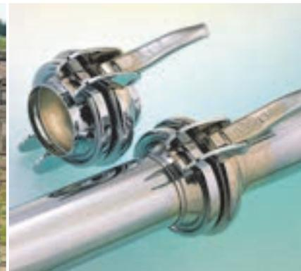
**Tubo HK de engate rápido**, em aço galvanizado extra leve, resistente à pressão e à sucção, com acoplamento por intermédio de alavanca, de acordo com a norma **DIN 19651**.
