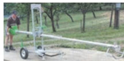
AGITADOR ACCIONADO PELA TOMADA DE FORÇA DO TRACTOR, VEIO DE 4m
